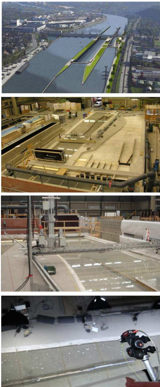
Slika 10.5: Prevodnica Ivoz-Ramet; odozgo na dole: fotomontaža budućeg objekta; model celine u razmeri 1:50; pokretni robotizovani uređaj za merenje rasporeda brzine i protoka; video snimanje strujnica [72, 109].
