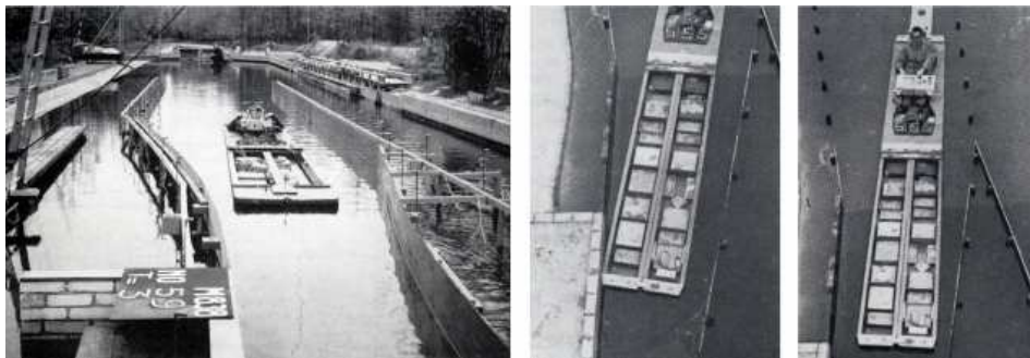
Slika 10.3: Modeli usmeravajućih građevina i potiskivanog sastava u razmeri 1:25. Ova razmera je omogućila da modelom plovnog objekta upravlja obučeni laborant koji sedi u modelu, pri čemu je razmera za brzinu plovidbe 1:5 [48].
