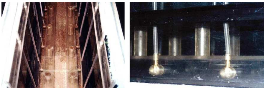
Slika 10.12: Pijezometri između otvora i njihovi priključci.
