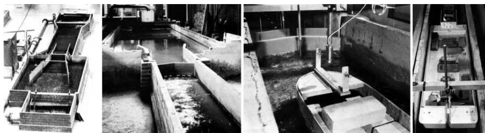
Slika 10.8: Model brodske prevodnice u Hidrauličkoj laboratoriji Instituta „J. Černi“; sleva udesno: model celine; punjenje komore; sonde za merenje nivoa u komori i merenje pomeranja broda.
