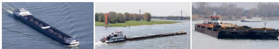
Slika 2.4: Strana teretna plovila na Dunavu; sa leva udesno: samohodni motorni brod nosivosti 3922 t ( 135/11,45/3,6 m); sastav „2×1” nosivosti 12000 t (potiskivač: 32/11/1,85 m; 2 \times 1120 kW; potisnice: 76,5/11,45/2,5 m); sastav „2×2” nosivosti 24000 t (potiskivač: 39,88/11,38/1,70 m; 2 \times 2200 kW; potisnice: 76,5/11,45/2,5 m) [105].
