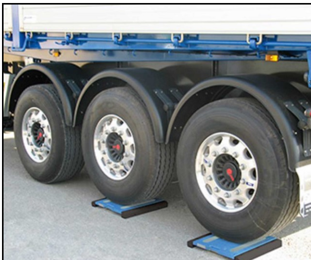
Слика 2. Различити типови вага: лево - вага за мерење осовинског оптерећења [9]; десно - вага за мерење укупне тежине возила [10]
