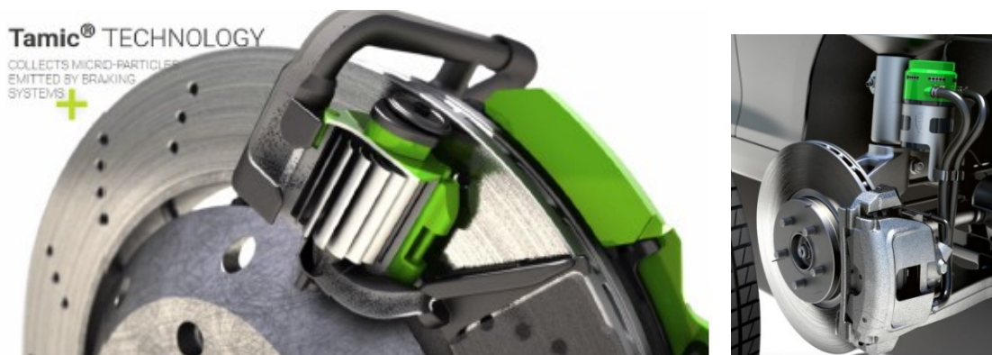
Slika 12. Koncept tehnologije na vozilu za sakupljanje čestica Izvor: (Gramstat, 2018, Meunier, 2018)
