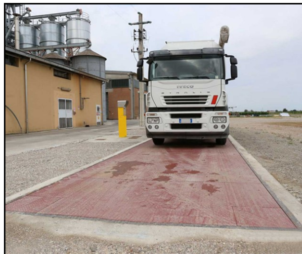
Слика 2. Различити типови вага: лево - вага за мерење осовинског оптерећења [9]; десно - вага за мерење укупне тежине возила [10]
