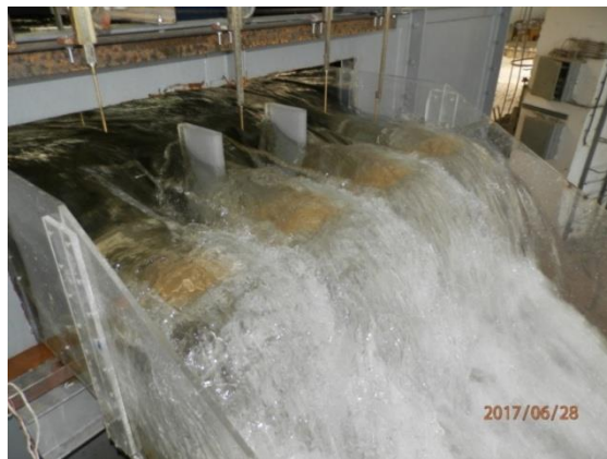
Slika 13. Uticaj mostovskih stubova na tečenje pri protoku Q_{0,01\%} = 965 m 3 /s.
