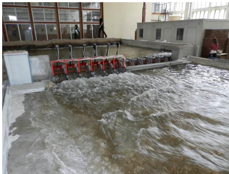
Slika 8. Hidraulički uslovi nizvodno od preлива, HE van pogona, Q_{PMF}=12800 m 3 /s, MIN Zds.
