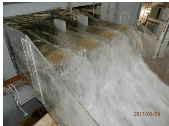
Slika 10. Uslovi tečenja na PK preliivu pri protoku Q_{0.1\%} = 740 \text{ m}^3/\text{s} .
