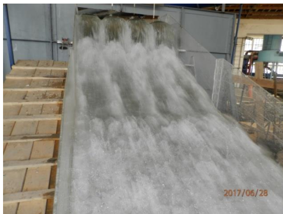
Slika 10. Uslovi tečenja na PK preliivu pri protoku Q_{0.1\%} = 740 \text{ m}^3/\text{s} .
