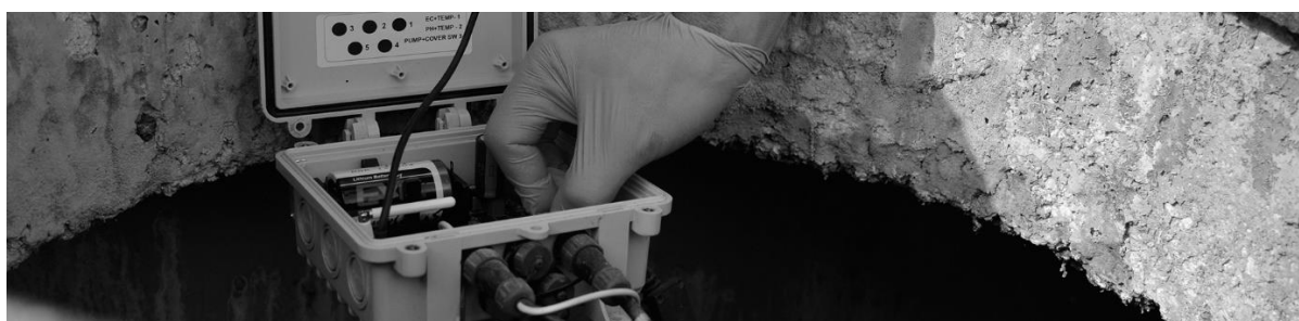
Slika 10. Jedinica sa sensorima za registrovanje zagađenja
