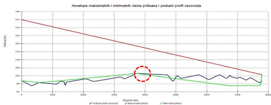
Slika 5. Anvelope maksimalnih i minimalnih pritiska i poduzni profil terena - sa jednim ventilom
