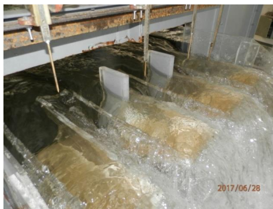
Slika 14. Uticaj mostovskih stubova na tečenje pri protoku Q_{0,1\%} = 740 m 3 /s.
