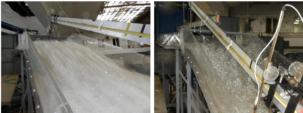
Slika 7. Deonica nizvodno od promene nagiba brzotoka za varijantu I (levo) i II (desno) pri Q_{0,1\%}=236 \text{ m}^3/\text{s} .
