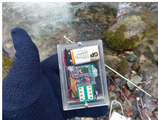
Slika 5. CDM324 radarski komplet Figure 5. CDM324 radar
