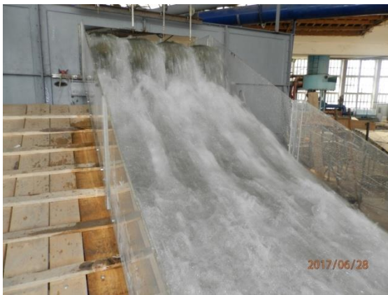
Slika 9. Uslovi tečenja na PK preliivu pri protoku Q_{0.01\%} = 965 \text{ m}^3/\text{s} .
