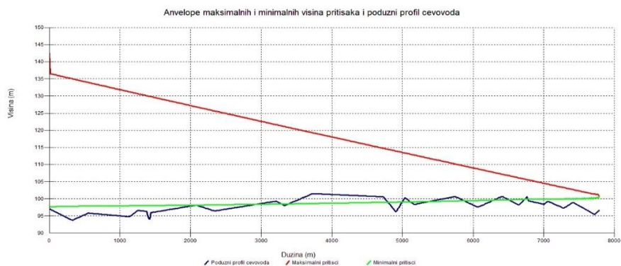
Slika 6. Anvelope maksimalnih i minimalnih pritiska i poduzni profil terena - sa posudom pod pritiskom
