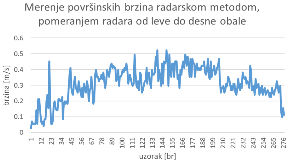
Slika 10. Radar rezultati pomeranjem senzora sa jedne na drugu obalu
