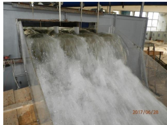
Slika 9. Uslovi tečenja na PK preliivu pri protoku Q_{0.01\%} = 965 \text{ m}^3/\text{s} .
