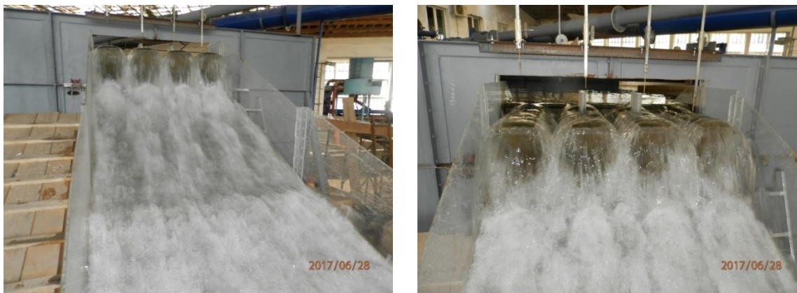
Slika 11. Uslovi tečenja na PK prelivu pri protoku Q_{1\%} = 478 \text{ m}^3/\text{s} .
