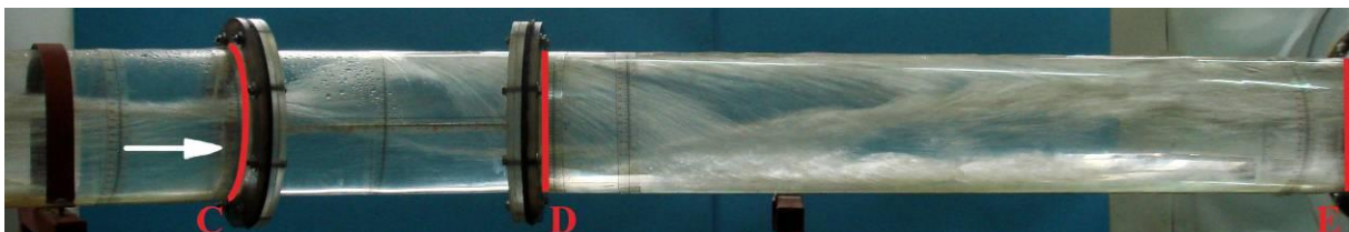
Слика 2. Хеликоидно течење у проводнику са хоризонталном кривином Figure 2. Helical flow in the conduit with the horizontal bend
