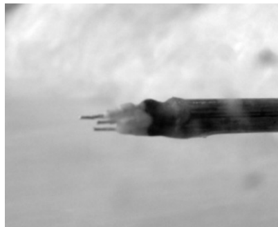
Slika 2. Senzor za merenje elektroprovodnosti, sa tri elektrode [5].
