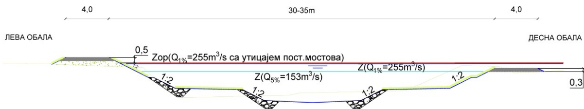
Слика 8. Реконструкција-надвишење обала Црнице узводно од уже градске зоне Параћина Figure 8. Reconstruction- heighten of the Crnica River banks upstream of Paracin downtown area
