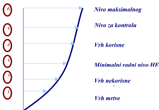
Slika 1: Indeksni nivoi karakterističnih zapremina akumulacije u modelu HEC 5 [6]
