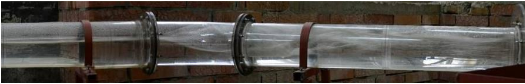
Slika 8. Helikoidno tečenje na fizičkom modelu Figure 8. Helical flow (physical model)
