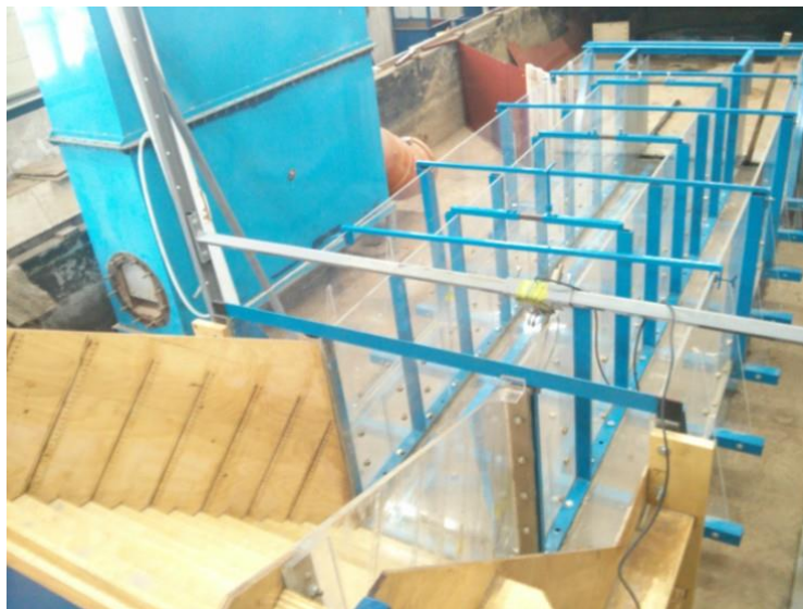
Слика 1. Физички модел за испитивање хидродинамичких притисака Figure 1. Physical model for studying hydrodynamic pressures
