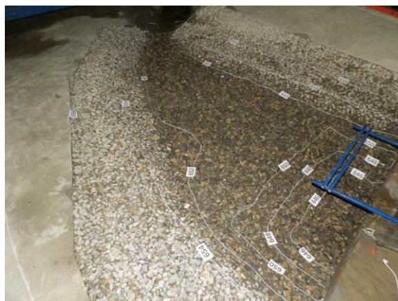
Slika 20. Erozija nizvodno od slapišta pri Q_{1\%} , projektovana nizvodna zaštita. Figure 20. Erosion downstream from the stilling basin at Q_{1\%} , including designed downstream protection.
