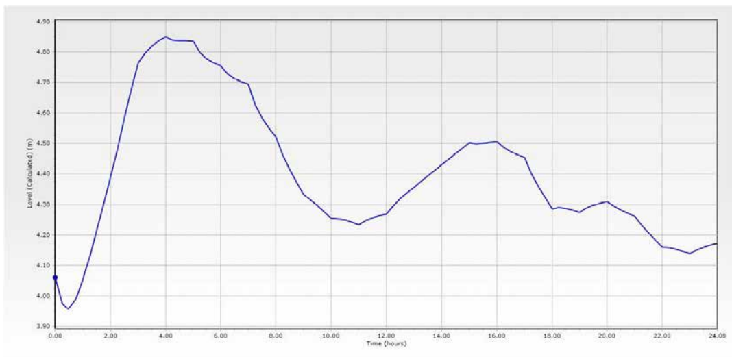
Slika 3. Dijagram nivoa vode u rezervoaru D. Vis tokom 24h Figure 3. Diagram of water level in the D. Vis reservoir for 24h
