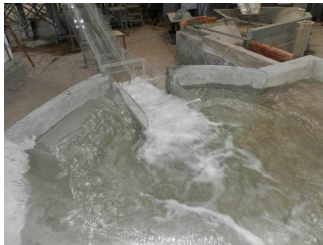
Slika 13. Tečenje na izlasku iz umirujućeg bazena pri Q_{0,1\%} , projektovano rešenje. Figure 13. Flow at the downstream end of the stilling basin at Q_{0,1\%} , initial design.
