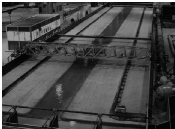
Слика 3. Лабораторијски канал за испитивање течења у кориту за велику воду [8]
