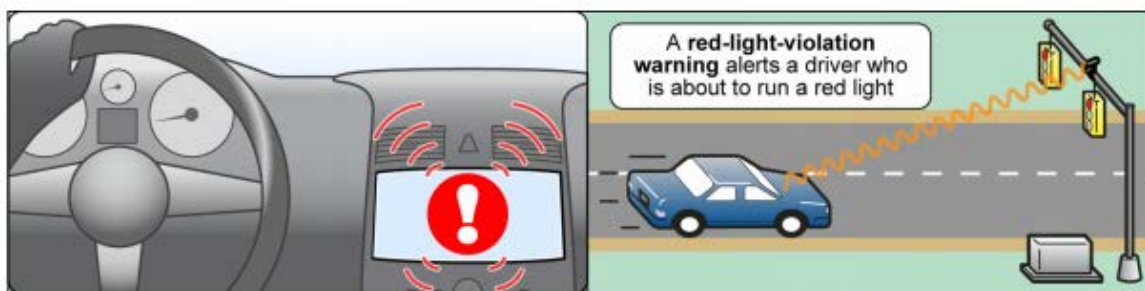
Slika 2. V2I uređaj za detektovanje mogućeg prolaska na crveno svetlo Source: (US GAO-15-775)
