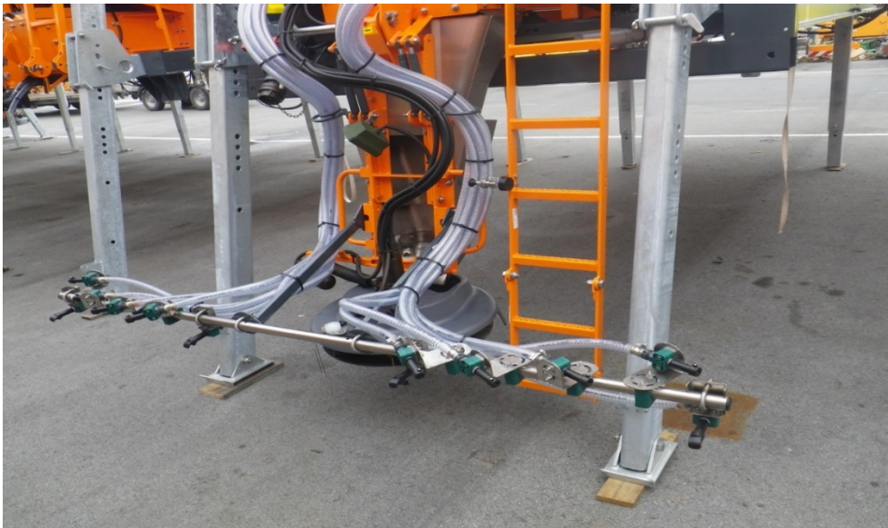
Slika 6. Sistem za distribuciju materijala za posipanje kod posipača FS30, FS50, FS70 i FS100 (tečnost za posipanje se distribuira pomoću posebne rampe sa mlaznicama za prskanje) Izvor: Rasco d.o.o.
