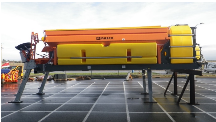
Slika 4. Posipač sa povećanim sadržajem tečnog sredstva za posipanje
