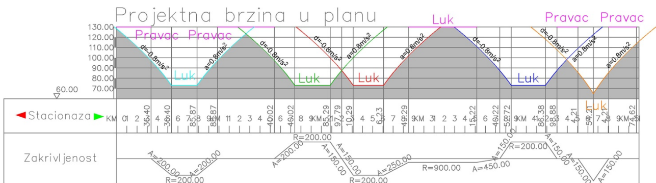
Slika 2. Konstrukcija dijagrama projektne brzine na osnovu elemenata situacionog plana
