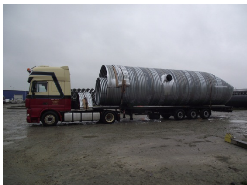
Slika 10. Specijalni transport i istovar čelične spiralne cijevi HC DN 3000, DN2200 i DN2000
