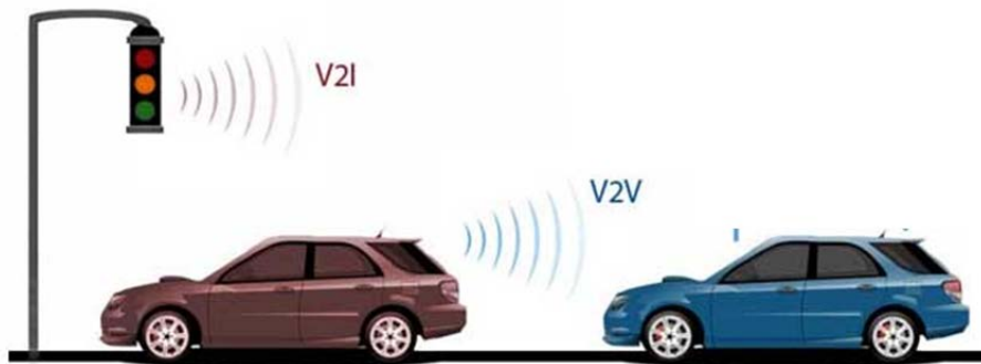
Slika 1. Koncept V2V i V2I uređaj za detektovanje mogućeg prolaska na crveno svetlo
