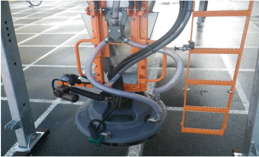
Slika 5. Sistem za distribuciju materijala za posipanje kod posipača FS30, FS50, FS70 i FS100 (tečnost za posipanje se distribuira pomoću tanjira za posipanje) Izvor: Rasco d.o.o.
