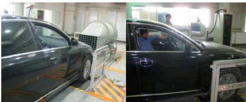
Slika 3. Vozilo radi pomoću sistema za testiranje emisija od vozila (VETS)
