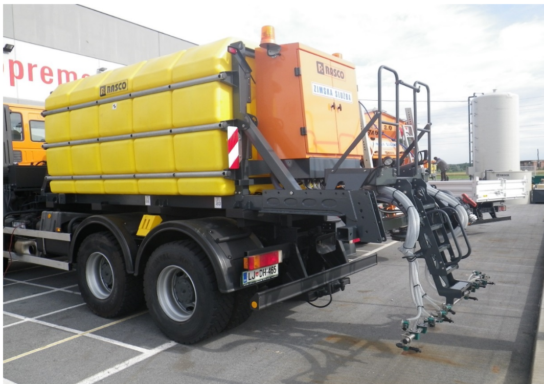
Slika 7. Posipač za FS100 posipanje, pomoću rampe sa mlaznicama sa mogućnošću posipanja širine do 12m
