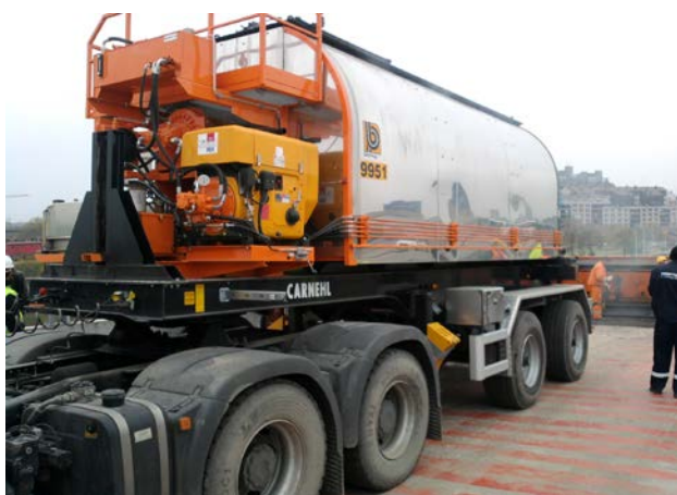
Slika 1. Pokretna mešalica za pripremu livenog asfalta (JKP "Beogradput")
