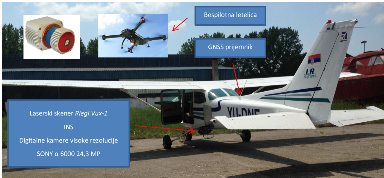
Slika 2. Mobilna vazдушna platforma (avion) za lasersko skeniranje terena ALS (GeoGIS Konsultanti, Beograd)
