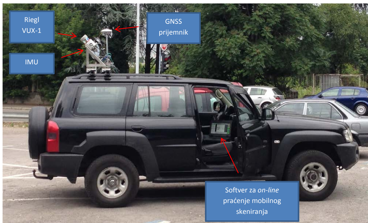
Slika 1. Mobilni sistem za skeniranje MLS Riegl VUX-1 (GeoGIS Konsultanti, Beograd)
