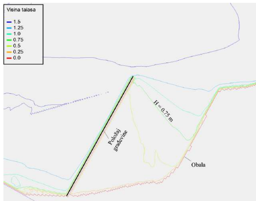
Slika 4. Raspored visina talasa dobijen na osnovu simulacije propagacije talasa uz interakciju talasa sa naperom
