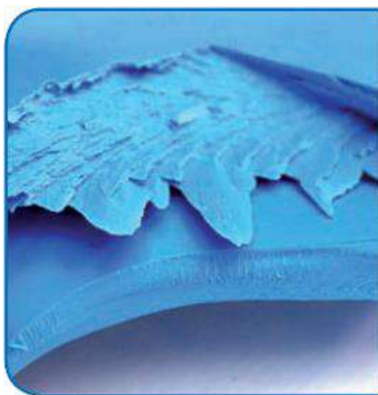
Slika 3. Struktura standardnog PVC (dole) i molekularno orijentisanog PVC materijala (gore)
