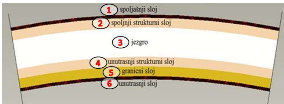
Slika 1. Tipiski strukturni presek GRP cevi
