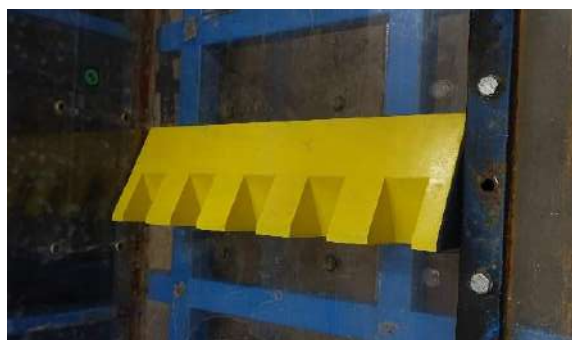
Слика 4. Низводни, назубљени праг умирујућег базена.
