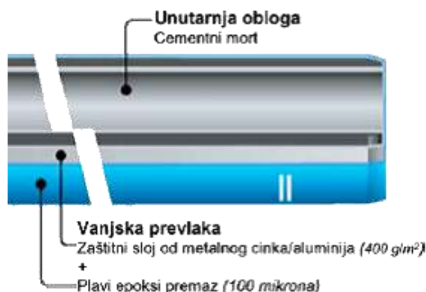
Slika 5. Tipični strukturni presek duktilne gvozdene cevi
