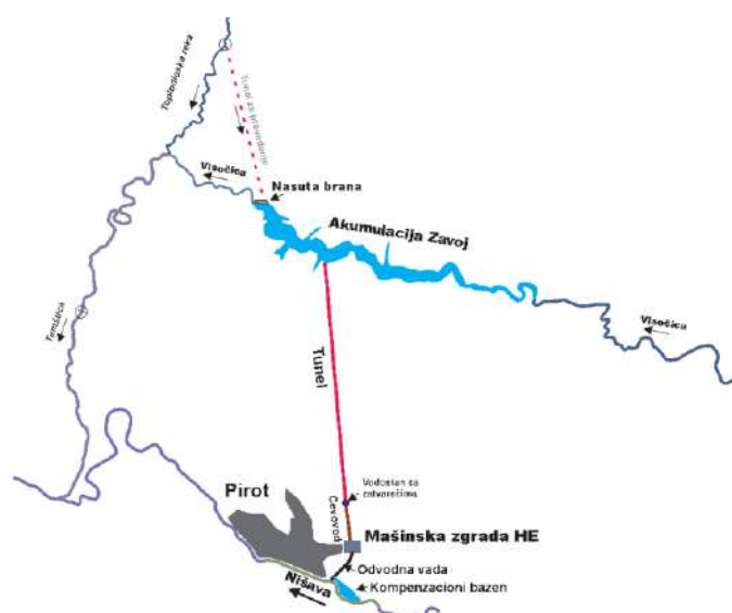
Slika 2. Dispozicija vodoprivrednog sistema Pirot sa ključnim elementima
