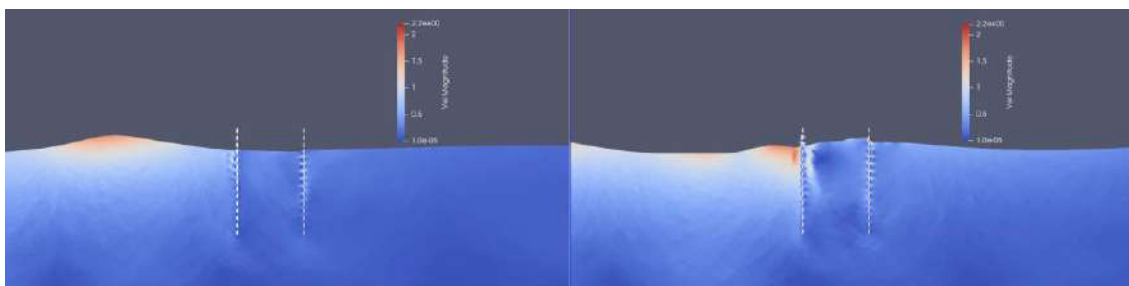
Slika 8. Prikaz fluidnih delića u zoni odbojnika 13 (levo) odnosno 19 (desno) sekundi nakon početka simulacije
