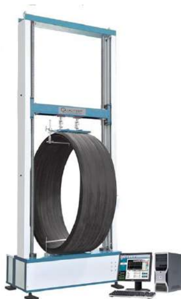
Slika 10. Izgled aparature za testiranja obodne krutosti SN
