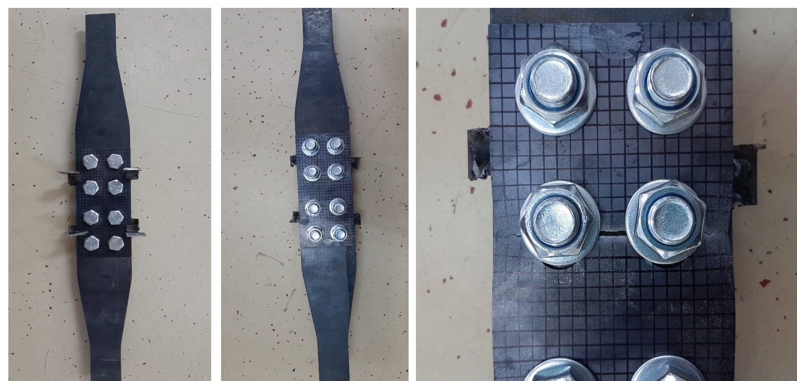
СЛИКА 4. Узорак серије 2 – пре и после лома
