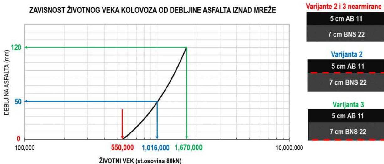
Slika 15: Kriva (linearne) zavisnosti životnog veka od debljine asfaltnog pojačanja iznad mreže
