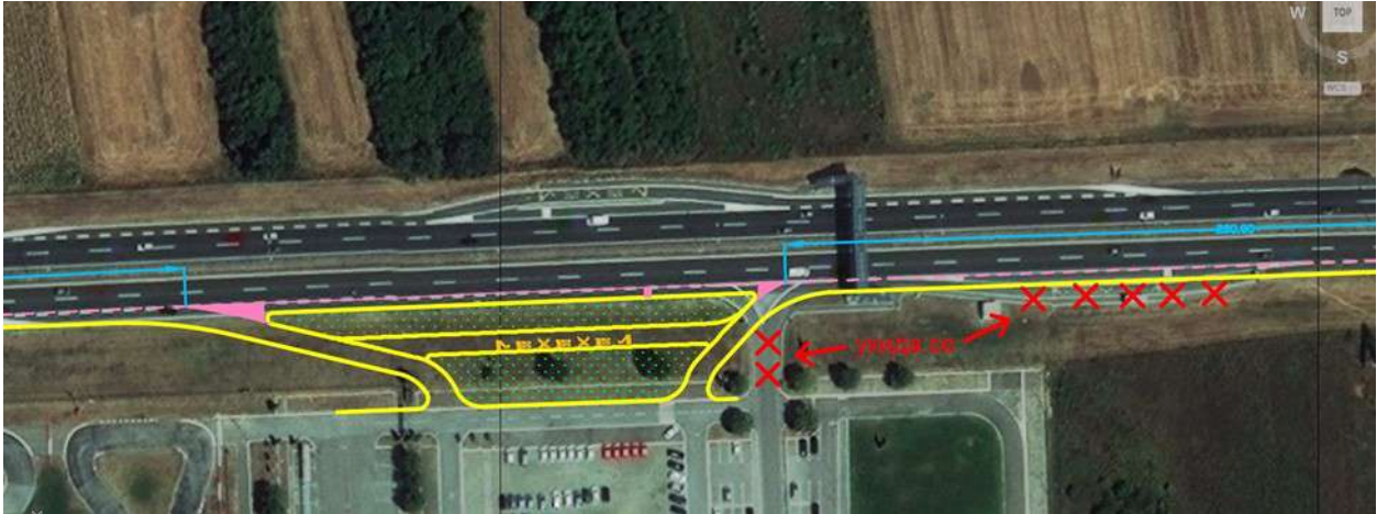
Slika 7. Rekonstrukcija predmetnog priključka
