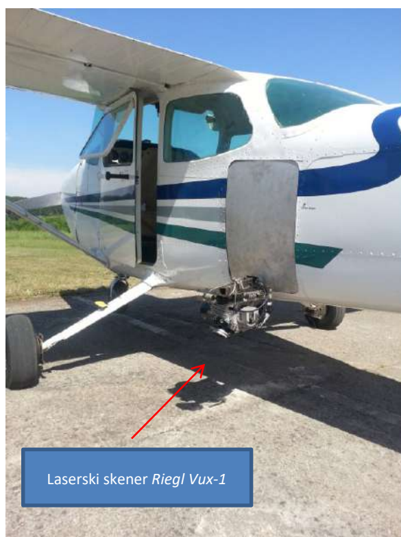
Slika 5. Mobilna vazдушna platforma (avion) sa laserskim skenerom Riegl VUX -1 (Izvor: GeoGIS Konsultanti, Beograd)
