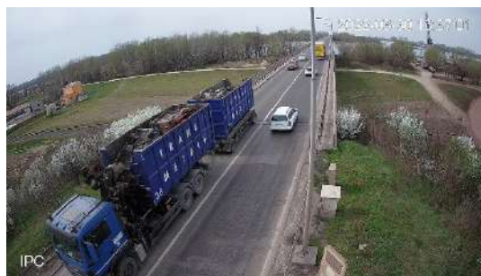
fotografija 7: prikaz vozila sa time stampom koja uzrokuju izmerene poremećaje ubrzanja na središnjoj tački mosta(2022/03/30 23:37, smer Kovin –Smederevo)
