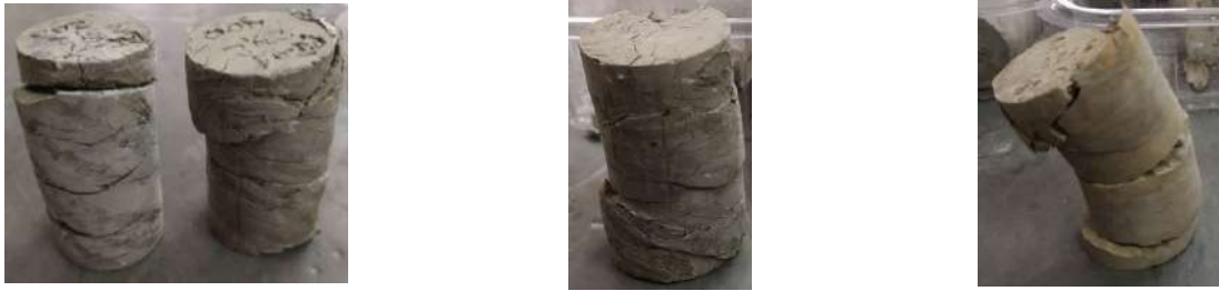
Slika 7. Izgled uzoraka bez jasno definisanih površina smicanja nakon ispitivanja u triaksijalnom aparatu
