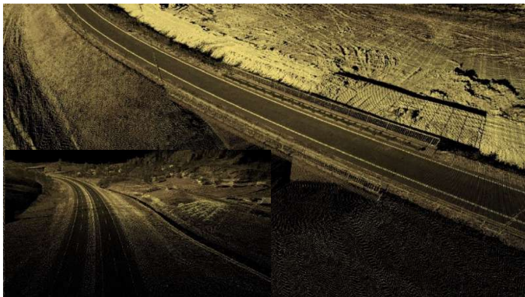
Slika 8. Oblak tačaka elemenata saobraćajne infrastrukture (Izvor: GeoGIS Konsultanti, Beograd)
