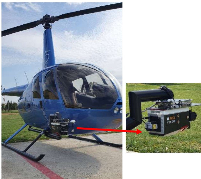
Slika 2. Vazдушna platforma za lasersko skeniranje (helikopter) sa laserskim skenerom skener Riegl VUX-240 (Izvor: GeoGIS Konsultanti, Beograd)
